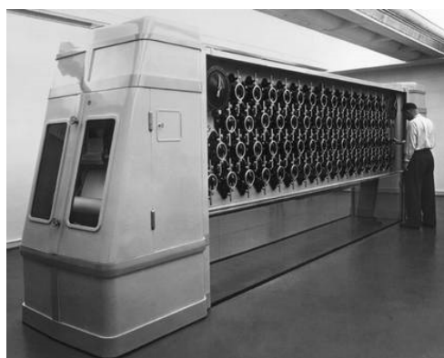
Abb. 7: Die zweite deutsche Gezeitenrechenmaschine (1935–1939).
