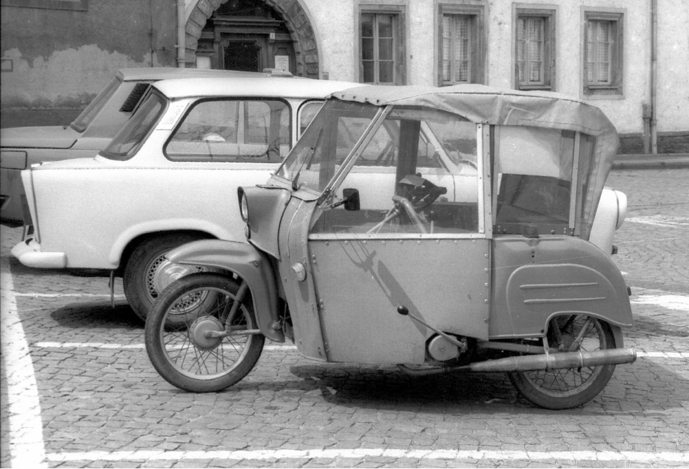
Ein »Krause-Duo«, ein »Versehrtenfahrzeug« mit Bauteilen des Mopeds Simson Schwalbe, auf einem Parkplatz in Karl-Marx-Stadt. Das Fahrzeug verfügte über keinen Rückwärtsgang. (picture-alliance/zb/Paul Glaser [1941–2022]; Foto von 1990)
