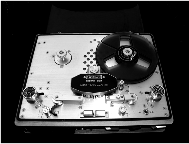
Aufnahmegerät „STELLAVOX“. Herstellungsdatum ab 1967; Akkuleistung bei Aufnahme 30 Minuten; Maße: 21 cm x 27 cm x 9 cm; Gewicht: 3.450 Gramm (Foto: Uta C. Schmidt)
